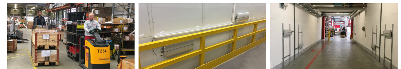
Abbildung: Nachschub mit erhöhter Prozessqualität: Leere RECARFID KLT-Behälter werden als solche erkannt und in nur einer Fahrtrichtung durch die Kathrein RFID Gates eindeutig gelesen. Sie werden somit von den vollen Behältern automatisch unterschieden.
