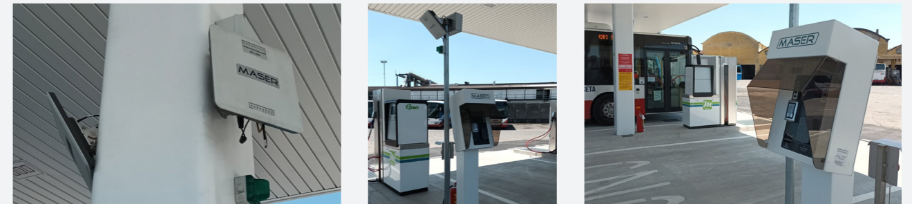
Abbildungen: Die RFID-Reader wurden direkt über der Zapfsäule abwärtsgerichtet angebracht und ermöglichen so eine exakte und automatische Fahrzeugidentifikation. Das führte zu einer deutlichen Beschleunigung des Tankvorgangs und lieferte Daten über Tankfrequenz und Energiekosten für das Controlling.
