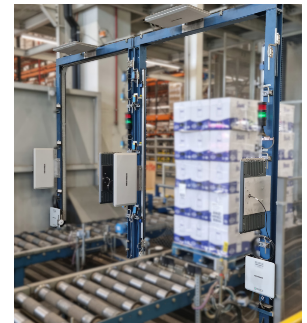
Abbildung: RFID-Gate/RFID-Zählstation, Erfassung auf zwei Rollbahnen
