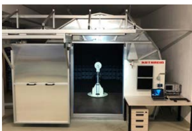
Abb.: Absorberkammer für automatisierte Transpondermessungen sowie Testbereiche für versch. Anwendungen
