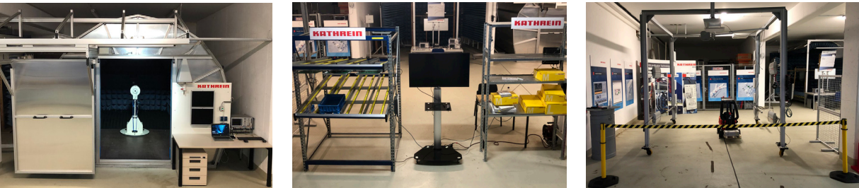
Abb.: Absorberkammer für automatisierte Transpondermessungen sowie Testbereiche für versch. Anwendungen
